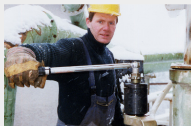
Применение ручного гайковёрта alkitronic® - модель HG 30 в промышленности, точное затягивание соединения при помощи динамометрического ключа.
