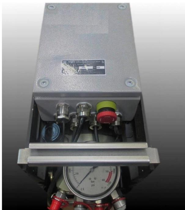
**Мануальное (ручное) управление:** поршневой цилиндр присоединенного гидравлического гайковерта выдвигается при нажатии кнопки. Цилиндр опять задвигается при отпускании кнопки через 2-3 секунды автоматически мотор выключается.
