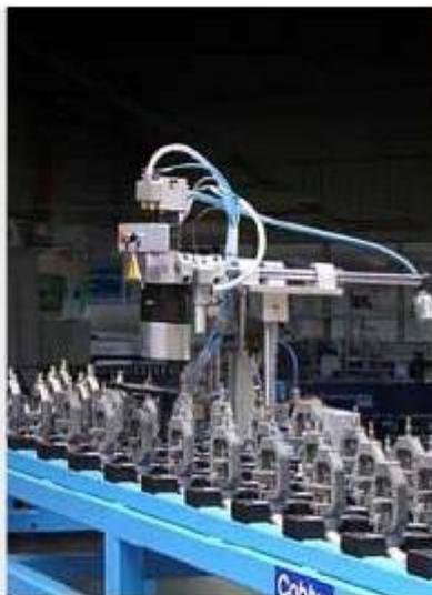
**alkitronic® CLV** работа на сборочном конвейере. Автоматическая затяжка с пультом дистанционного управления
